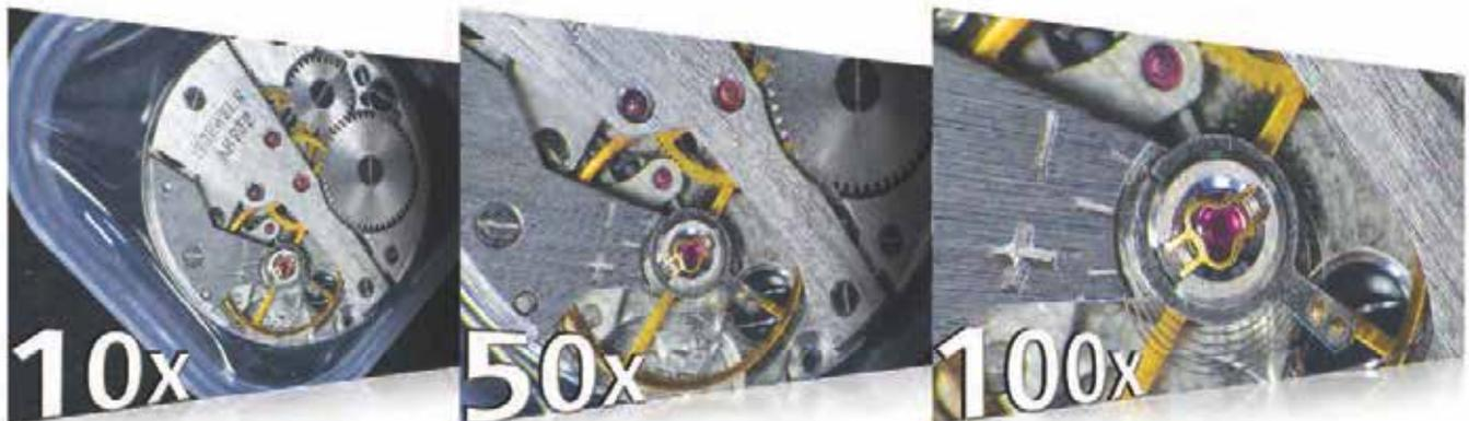
Le système Makrolite permet de visualiser des échantillons dans leur intégralité grâce à son très grand champ de vision. Il suffit de zoomer sans changer la mise au point pour procéder à une inspection dans les moindres détails. Grossissement de 10x à 100x avec la lentille DCR 250 (standard).
