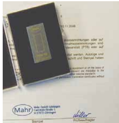
Etalon de rugosité PRN 10 Réf. 6820420 Fourni avec certificat d'étalonnage d'origine Mahr Etalon d'état de surface chromé à profil tourné. Hauteur de profil env. 10 µm pour le suivi et calibrage du M 300
