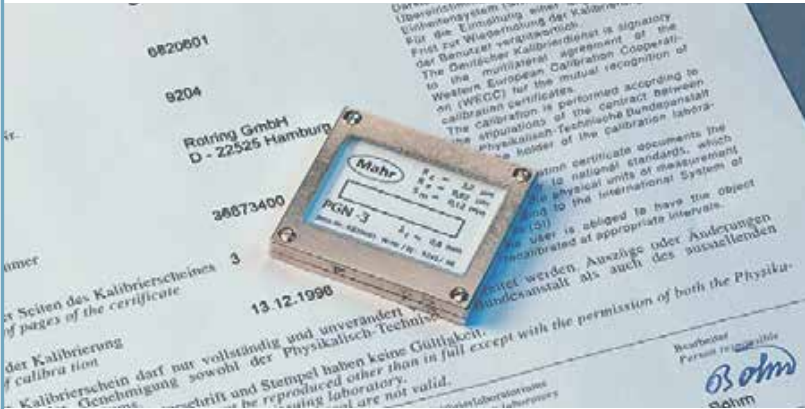
Etalon de rugosité PGN 3 Réf. 6820601 Etalon de rugosité à profil sinusoïdal. Hauteur du profil 3 µm, valeur env. Ra 1 µm, Pas moyen du profil 0,12 mm. Pour le suivi et calibrage du M 300. Certificat d'étalonnage Mahr pour PGN 3 Réf. 9027715 Certificat d'étalonnage DKD pour PGN 3 Réf. 6980102 Etalon de rugosité PGN 1 Réf. 6820602 Etalon de rugosité PGN 10 Réf. 6820605
