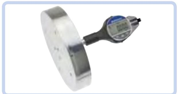
Tampon SmartPlug pour de grands diamètres (jusqu'à 280mm)
