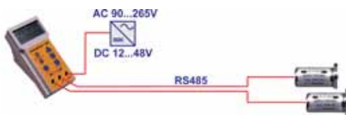
2 ZEROTRONIC sensors with / mit LEVELMETER 2000 Distance < 15 ... 20 m / Distanz < 15 ... 20 m
