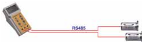
2 ZEROTRONIC sensors with / mit LEVELMETER 2000 Distance < 15 ... 20 m / Distanz < 15 ... 20 m
