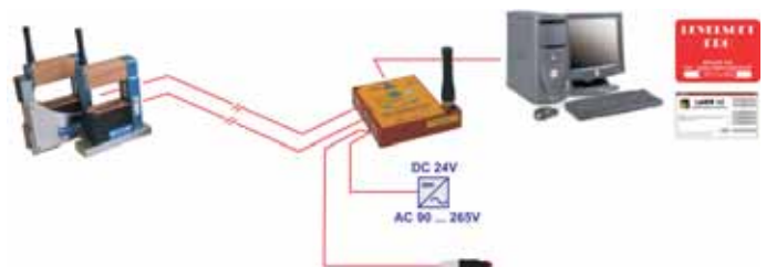
MINI T/C „Radio Module“ with 2 MINILEVEL NT connected to a PC, instruments connected by cables MINI T/C FUNK mit 2 MINILEVEL NT an PC über Kabel angeschlossen
