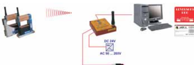
MINI T/C „Radio Module“ with 2 MINILEVEL NT connected to a PC by means of wireless data transmission MINI T/C FUNK mit 2 MINILEVEL NT an PC über Funk angeschlossen
