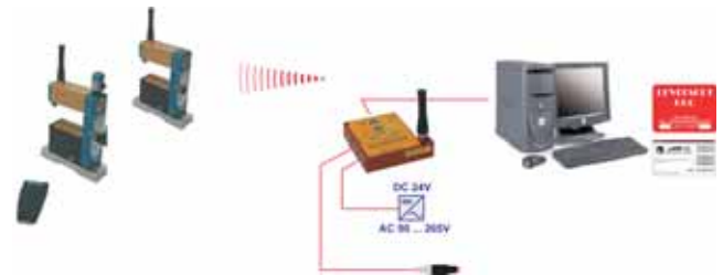
MINI T/C „Radio Module“ with 2 MINILEVEL NT connected to a PC by means of wireless data transmission / IR receiver on top of the measuring instrument MINI T/C FUNK mit 2 MINILEVEL NT an PC über Funk angeschlossen / IR Empfänger auf Messgerät aufgesetzt
