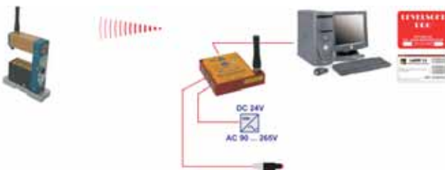
MINI T/C „Radio Module“ with 1 MINILEVEL NT connected to a PC by means of wireless data transmission MINI T/C FUNK mit 1 MINILEVEL NT an PC über Funk angeschlossen
